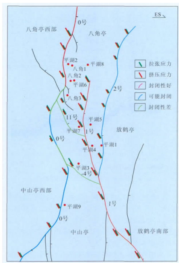
图3 平湖油气田构造应力及断层封闭性综合评价
