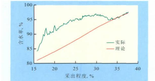
图 2 孤东油田七区西 Ng5<sup>4</sup>—6<sup>1</sup>注水区含水率与采出程度关系
