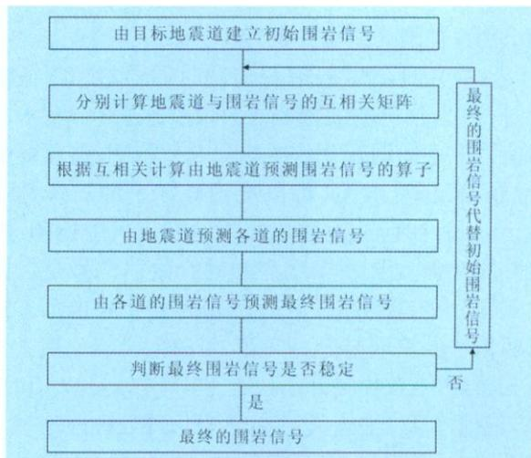
图2 盲信号分离处理技术实现流程
