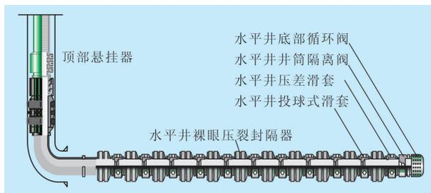
图1 裸眼封隔器分段压裂完井管柱示意
