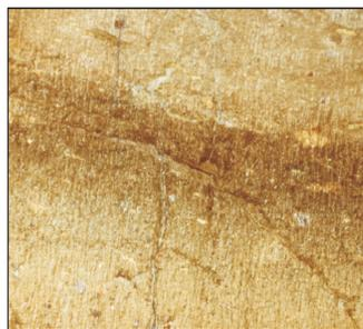
图2 实际观测到的页岩裂缝扩展和支撑剂铺置特征
