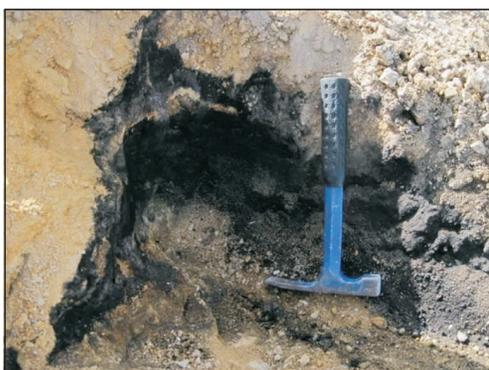
图2 绿梁山第四纪坡积物中残留的油砂
