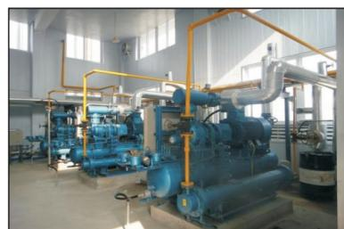
图12 精馏与低温提馏耦合分离回收装置
