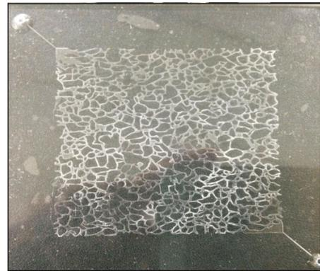
图2 多孔介质仿真模型
