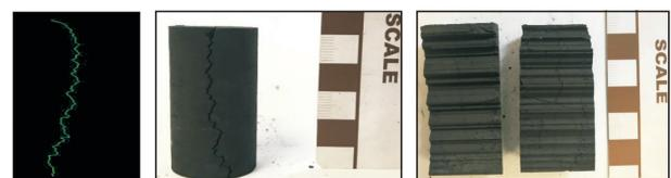
a—裂缝设计 b—人工裂缝样品 c—人工裂隙截面
