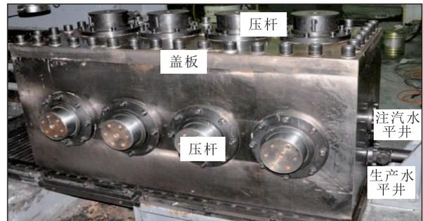
图4 真三轴模型实验装置
