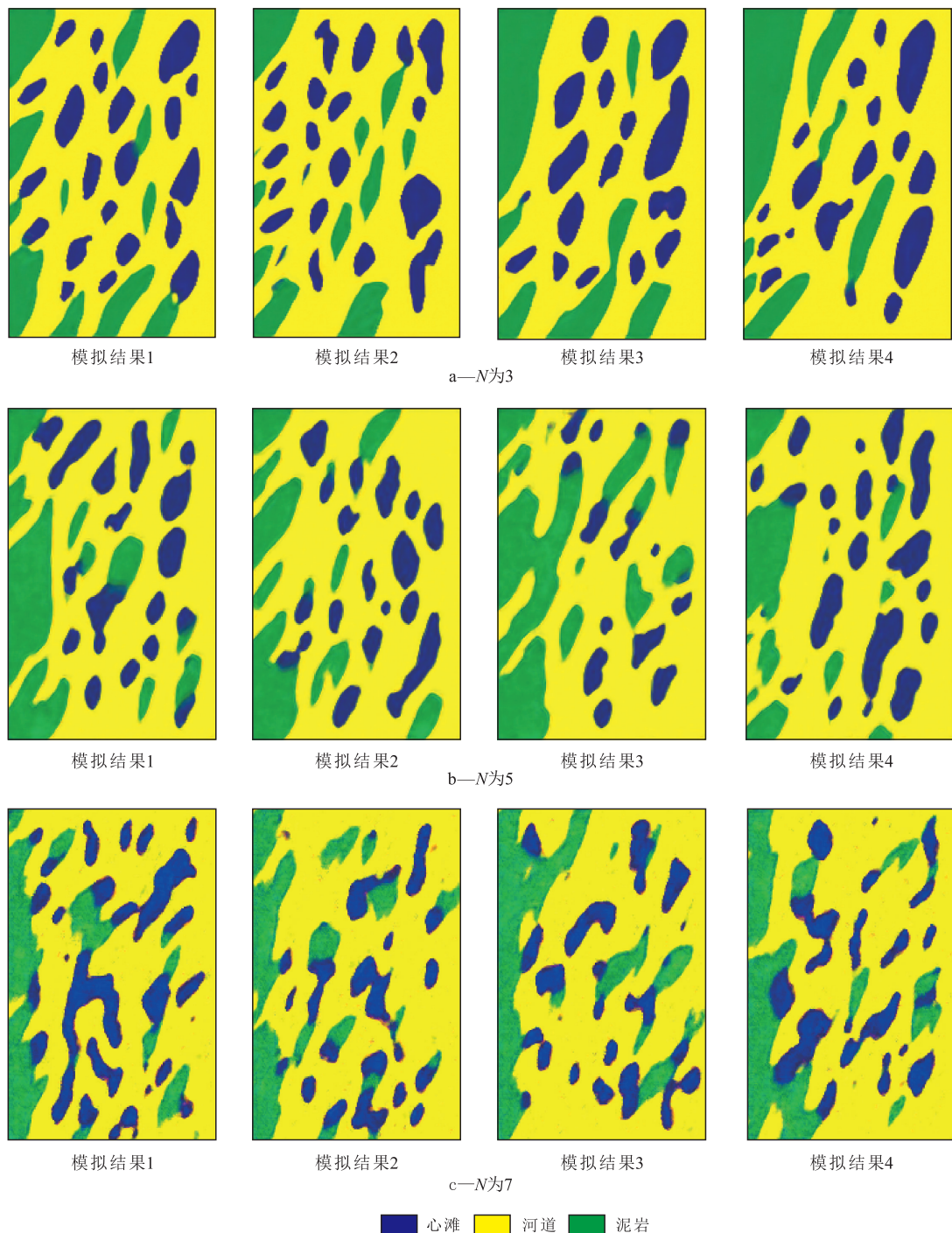
图4 基于相对平稳训练图像的SinGAN方法模拟结果
