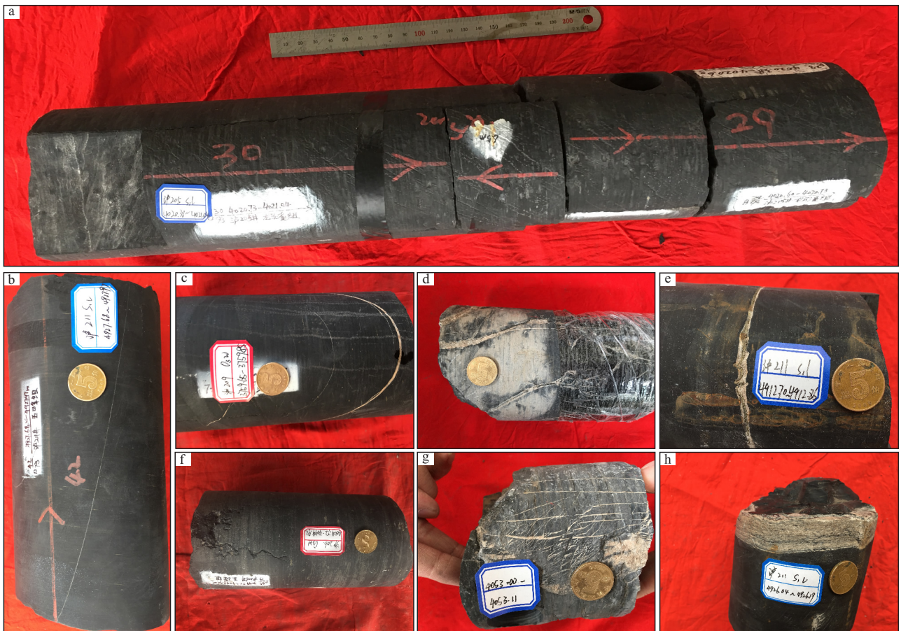
a—泸205井, 4 020.38~4 021.04 m, 直立缝, 未充填; b—泸211井, 4 927.68~4 927.97 m, 直立缝, 方解石全充填; c—泸209井, 3 759.65~3 759.85 m, 高角度缝, 方解石全充填; d—泸206井, 4 053.43~4 053.68 m, 直立缝, 方解石、沥青全充填; e—泸211井, 4 912.70~4 912.86 m, 水平缝, 方解石、黄铁矿全充填; f—泸206井, 4 049.72~4 049.92 m, 扭张缝, 沥青全充填; g—泸206井, 4 053.00~4 053.11 m, 异常高压缝, 方解石全充填; h—泸211井, 4 926.04~4 926.19 m, 溶蚀缝, 方解石全充填
