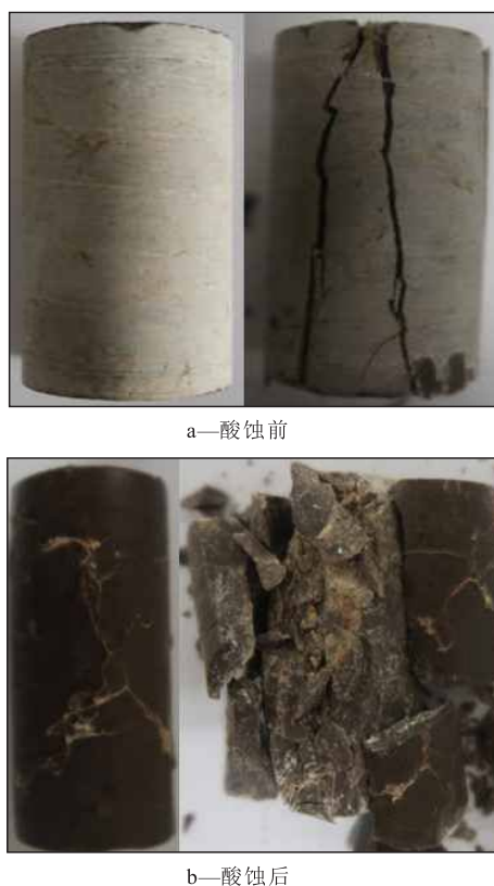
图 1 酸蚀前后拉伸破坏形态
