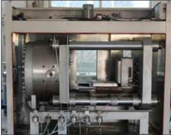
图1 300-R2真三轴水力压裂平台
