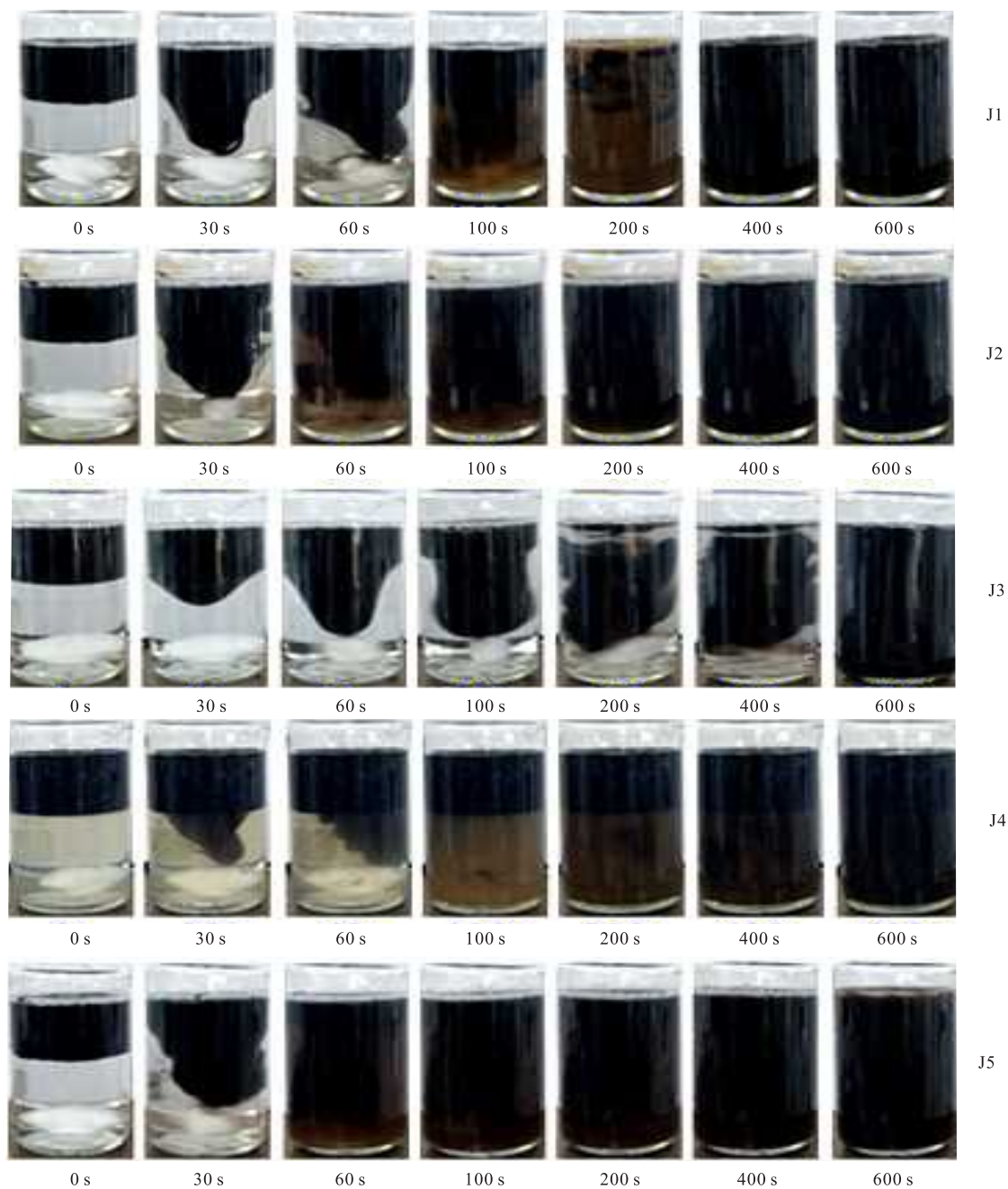
图4 不同降黏剂最小乳化转速测试结果
