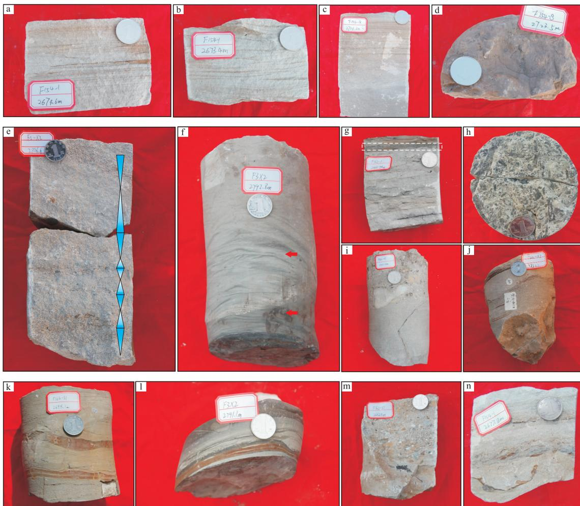
a—上部发育楔状交错层理、下部发育平行层理,樊154-1井,2 674.4 m;b—小型槽状交错层理,樊154-1井,2 673.4 m;c—平行层理,樊154-8井,2 736.2 m;d—底模构造,樊154-8井,2 723.5 m;e—逆-正粒序频繁互层,樊3-斜2井,2 806.6 m;f—爬升波纹层理和波状层理,樊2-斜2井,2 792.8 m;g—成层分布的黑色碳质植物碎屑,樊162-1井,2 660.94 m;h—顺层排列的黑色碳质植物碎屑,樊3-斜2井,2 762.1 m;i—冲刷面,螺化石发育,裂缝发育,樊162-斜7井,2 702.1 m;j—层内冲刷和泥岩撕裂屑,樊162-斜7井,2 732.7 m;k—红褐色泥岩条带,樊162-31井,2 698.1 m;l—红褐色泥岩条带和黑色碳质纹层,樊3-斜2井,2 791.1 m;m—冲刷面,樊162-31井,2 662.6 m;n—层内冲刷和红褐色泥砾,樊154-1井,2 677.8 m
