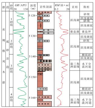
图 6 塔北隆起西部玉东 5 井库姆格列木群底砂岩段 沉积微相砂体响应特征
