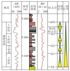
图 3 羊塔 5 井库姆格列木群标志层、层序界面、准层序组 界面及底砂岩段高精度层序地层单元划分
