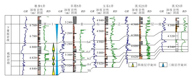
图 4 温宿凸起周缘-英买力隆起地区库姆格列木群底砂岩段连井高精度层序地层结构特征
