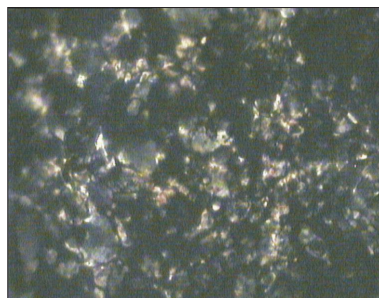
图1 岩心薄片油和束缚水分布 透亮处为以饱和地层水为主的部分,黑色主要为含油部分
