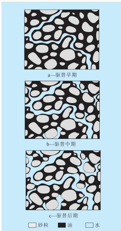
图3 微观驱油条件下的岩石孔隙波及特征
