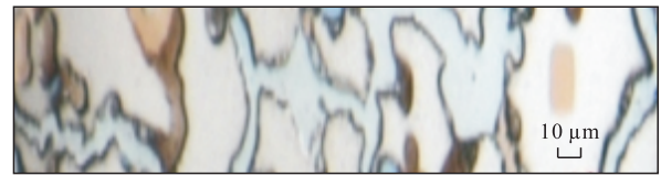
b—乳化速率为0.08 mL/min的表面活性剂驱
