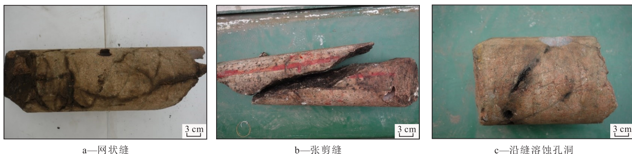
图1 中非乍得某基岩潜山岩心裂缝照片
