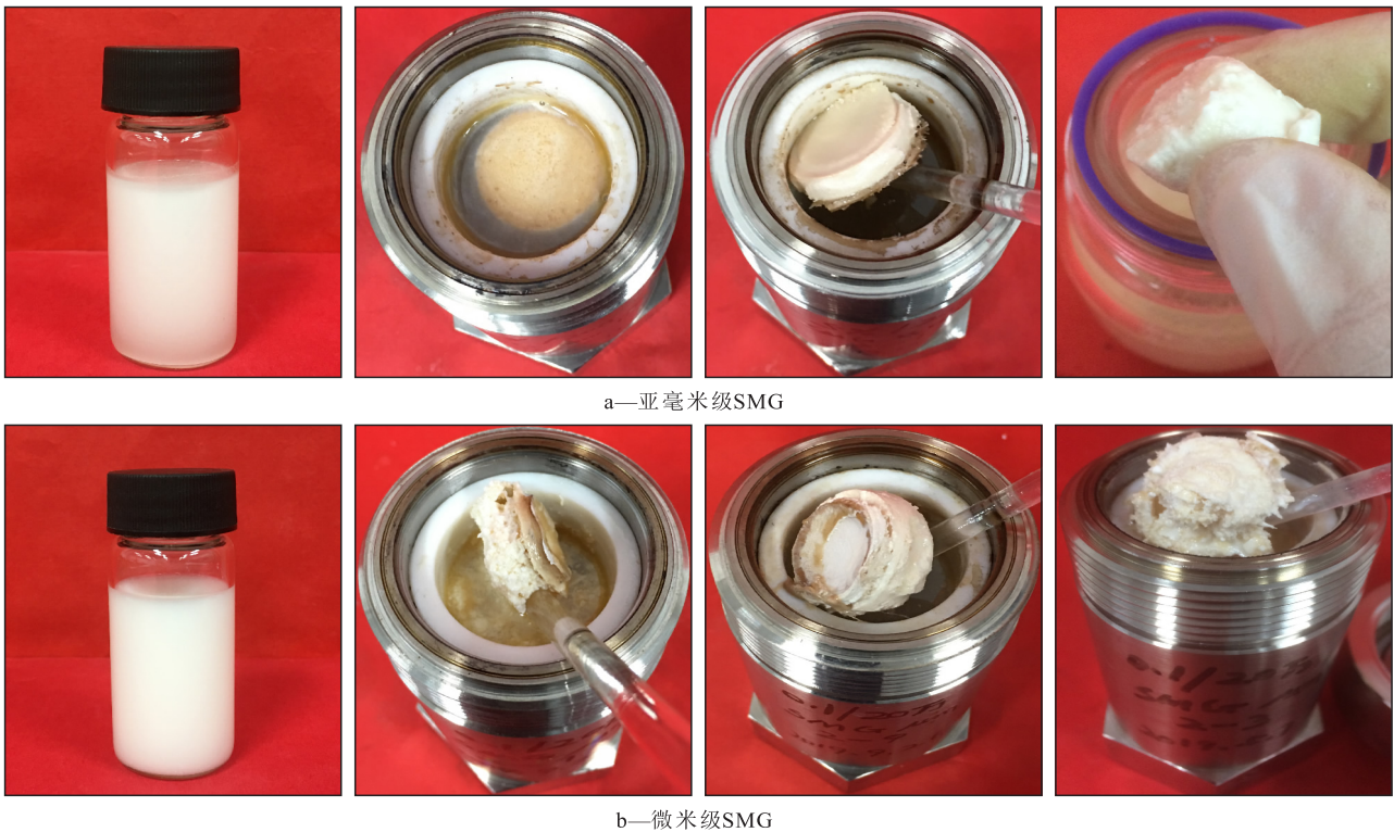
a—亚毫米级SMG b—微米级SMG 图片从左到右依次为老化前、老化1个月后、老化3个月后和老化6个月后 图1 老化前和不同老化时间后的亚毫米级和微米级SMG水分散液形貌对比
