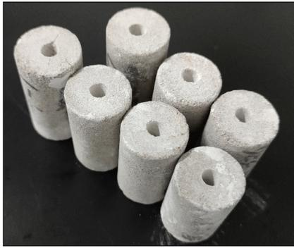
图3 压驱物理模拟实验岩样
