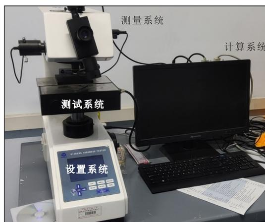
图3 压痕测试实验装置
