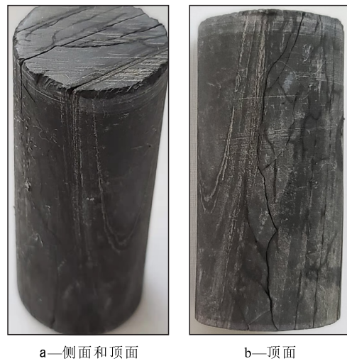
图7 S4岩样在渗吸过程中产生裂缝
