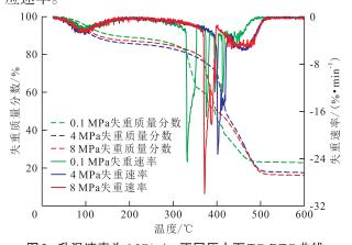
图 3 升温速率为 6 °C/min,不同压力下 TG-DTG 曲线 Fig. 3 TG-DTG curves under different pressures at temperature rise rate of 6 °C/min
