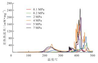
图4 不同压力下的DSC曲线
