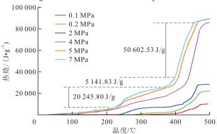
图 5 不同压力下的热焓值曲线 Fig.5 Enthalpy curves under different pressures
