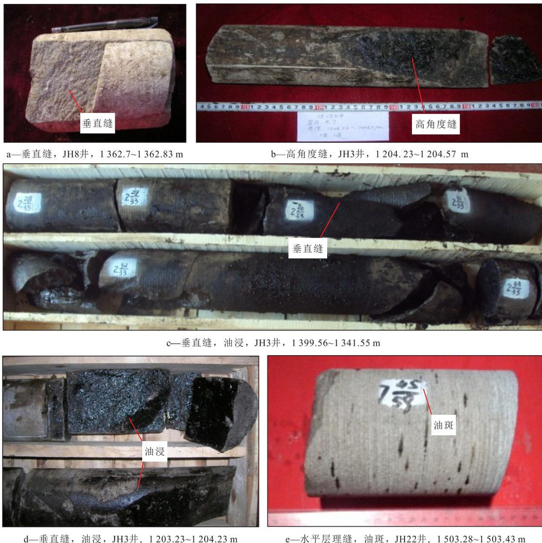
图 7 鄂尔多斯盆地西南缘延长组致密砂岩裂缝发育特征
